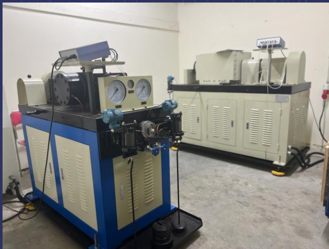
Машина для испытаний на ресурсное время
