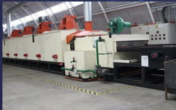
Установка для термообработки заготовок колец подшипников – электропечь WD-HH-100x14
